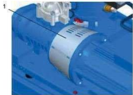
Рис. 5: Винтовой компрессор с прямым приводом
